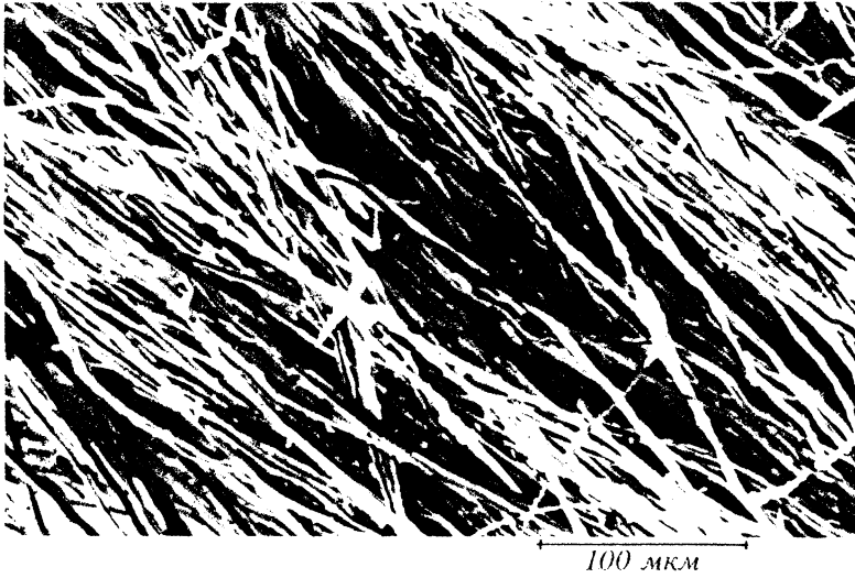
Рис. 1. Волокнистая масса хитинсодержащего материала «Микотон», СЭМ, \times 380
